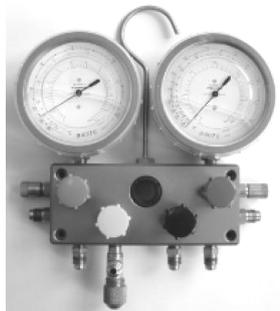
Figure 3.21 : Pont manométrique analogique
