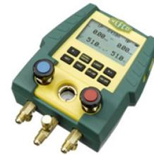
Figure 3.19 : Pont manométrique digital à deux voies
